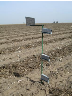
Figura nº 1: mástiles y colectores ubicados en las parcelas a campo.
